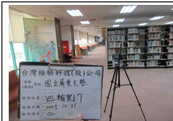
說明：室內空氣品質檢測 (CO 2 ) 日期：2025/10/31 地點：巡檢點7(#7)
