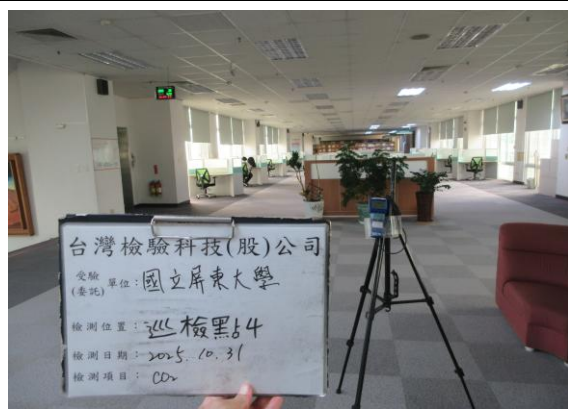
說明：室內空氣品質檢測 (CO 2 ) 日期：2025/10/31 地點：巡檢點4(#4)
