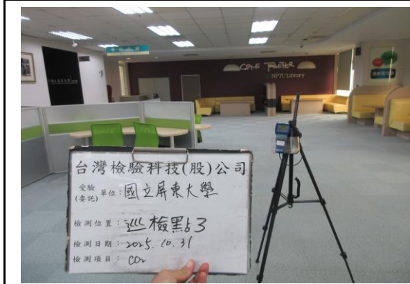
說明：室內空氣品質檢測 (CO 2 ) 日期：2025/10/31 地點：巡檢點3(#3)
